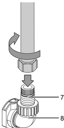
Como alternativa, pode aparafusar uma tubagem ou mangueira com rosca interior G1½" / DN40 diretamente no adaptador angular (8).
