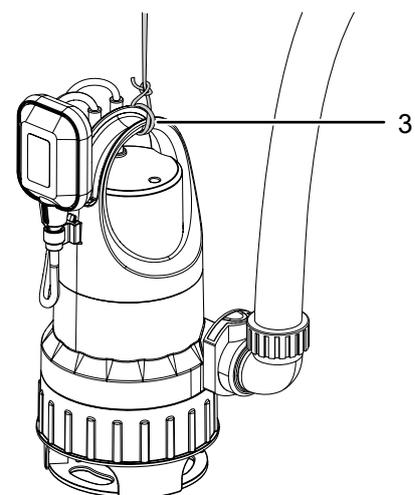
2. Submerja o aparelho de forma levemente inclinada na água, de forma a que o ar no aparelho possa escapar.
