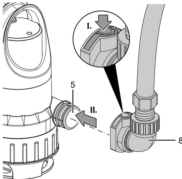
Para remover o sistema de encaixe tem de pressionar o botão vermelho no adaptador angular (8) puxá-lo para fora.
