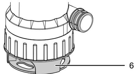
2. Para voltar da operação com água suja, deve girar a abertura de aspiração (6) no sentido dos ponteiros do relógio.
