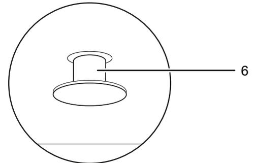
Apenas após a inserção completa do interruptor de proteção contra queda para dentro do aparelho pode utilizar o aparelho. Ao posicionar o aparelho sobre uma superfície adequada este interruptor liga-se automaticamente.
