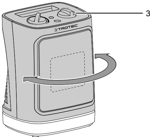
2. Coloque o interruptor de função (3) na posição I ou II para desligar de novo a oscilação.
